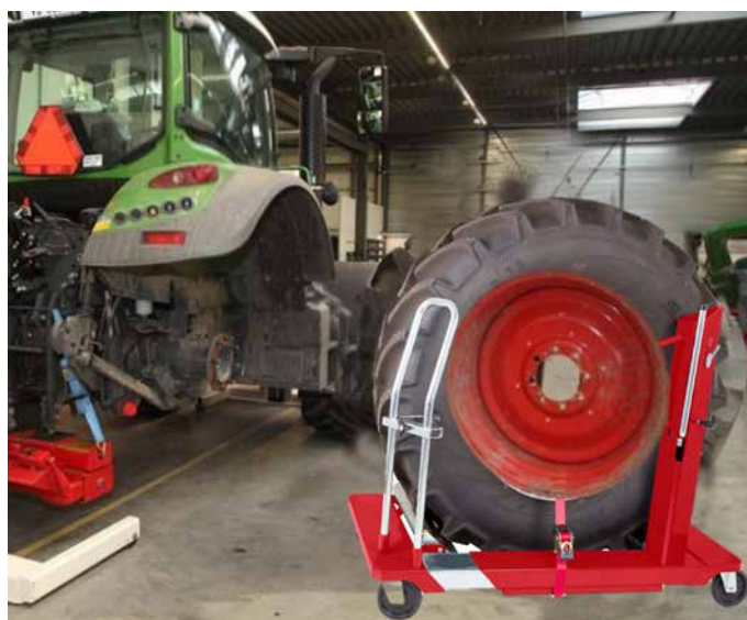
Wózek do kół umożliwiający wygodne i ergonomiczne wyciąganie dużych kół.
