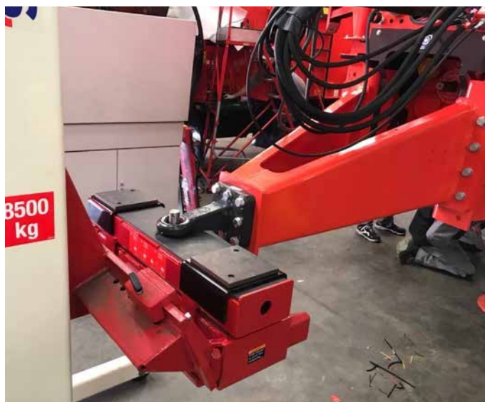
Adaptory wielofunkcyjne do podnoszenia pojazdu wolnego od kół z przodu i tyłu z dwoma lub trzema przestawnymi podnośnikami kolumnowymi.
