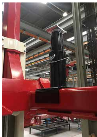
Belka poprzeczna ze sworzniem do bezpiecznego i stabilnego odłączania oraz niezależnego podnoszenia przyczepy z zestawu lub podwozia.
