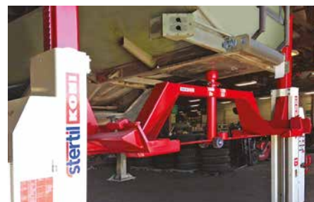
Belka poprzeczna ze sworzniem do bezpiecznego i stabilnego odłączania oraz niezależnego podnoszenia przyczepy z zestawu lub podwozia.
