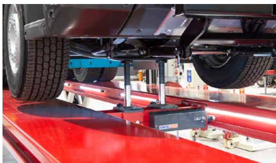
Regulowane podnośniki osiowe z dwoma cylindrami pasują do wszystkich platform.
